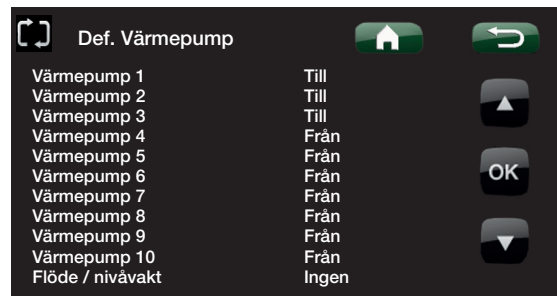
Exempel på system med 3 st. värmepumpar
