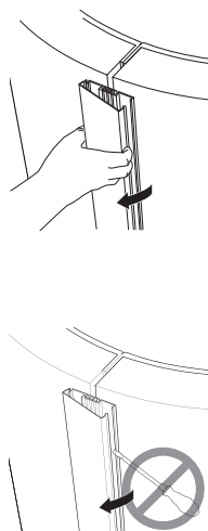
Använd inga verktyg för demontering av skarvskenan
