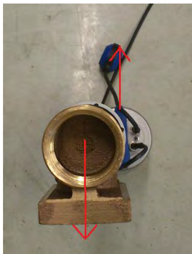
Pump och glidfäste ovanifrån. Notera att vippans riktning är 180 grader från utloppet på glidfästet.
